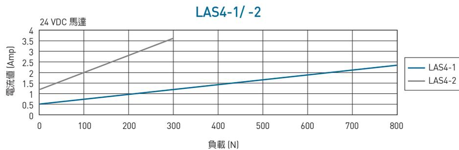
\*\*註：以上測試數據為搭配電源供應器 (24 VDC) 測試結果。
