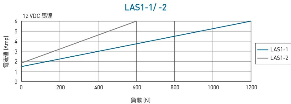
\*\*註：以上測試數據為搭配電源供應器 (12 VDC) 測試結果。
